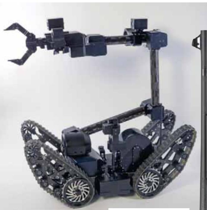
tels un bras articulé six axes d'une capacité de levage de 20 kg, des canons disrupteurs, des caméras, et autres capteurs ou détecteurs.
