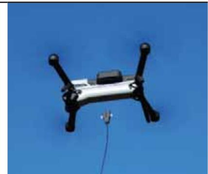
▲ Le drone NX70, vu larguant en vol son câble d'alimentation pour aller au plus proche de l'action
